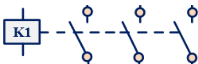
4. คอนแทคเตอร์หมุนขวา = K1 (Forward Contactor)
