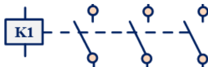
7. คอนแทคเตอร์หมุนขวา = K1 (Forward Contactor)
