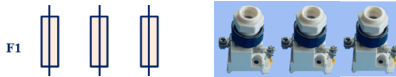
4. คาร์ทริกฟิวส์ วงจรกำลัง 3 ตัว = F1 (Power Fuse)
